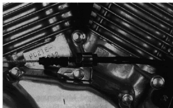
Bild 33 Unterer Kupplungseinsteller
