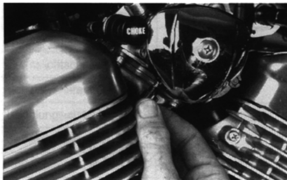
Bild 6 Leerlaufdrehzahl einstellen
