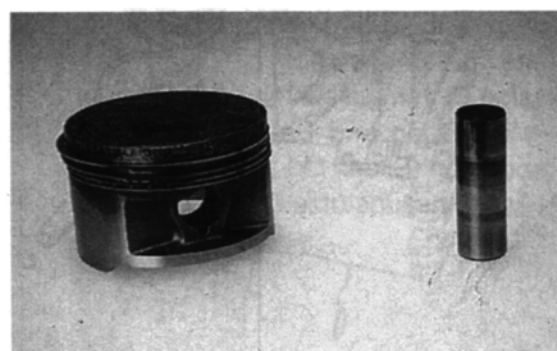
Bild 123 Kolbenbolzen und -bohrung messen
