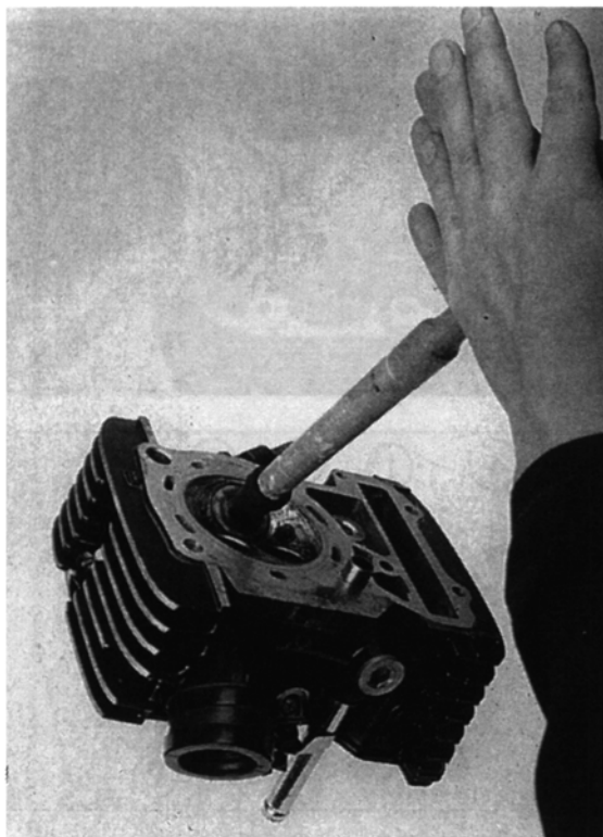
Bild 108 Unter leichtem Druck (4 bis 5 kg) quirlen und immer wieder versetzen
