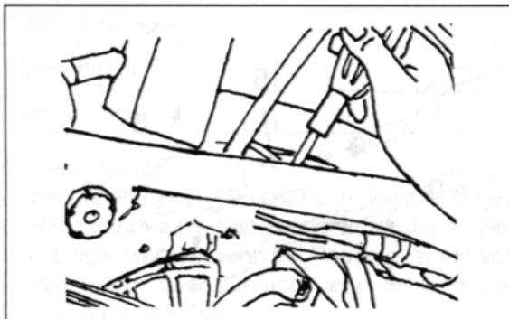
Bild 7 Vergaserabgleichsschraube
