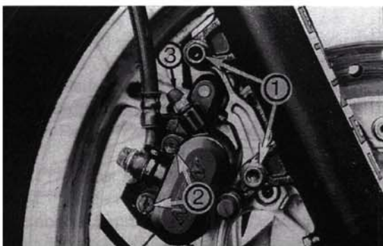
Bild 30 Bremssattel vorn (typgleich mit CBR 600 F) 1 Befestigungsschrauben 2 Madenschlitzschrauben 3 Entlüftungsventil
