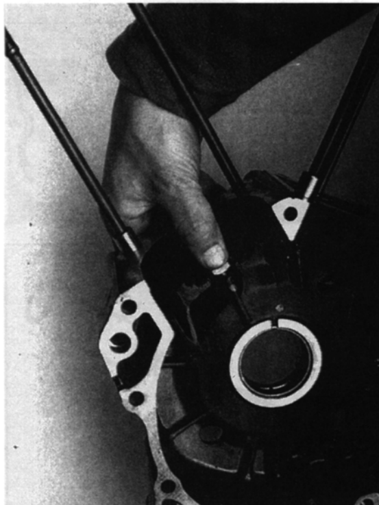
Bild 150 Ölspritzdüsen mit O-Ring eindrücken
